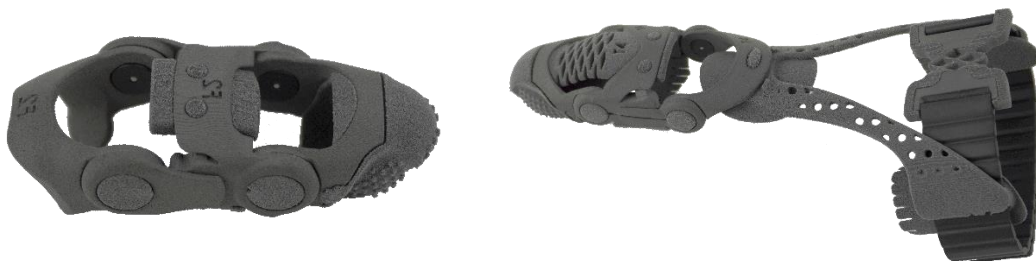
Figura 2: Las dos versiones del exoesqueleto ARTUS para los dedos. Izquierda: la versión ARTUS para los dedos. Derecha: La versión ARTUS para el pulgar
