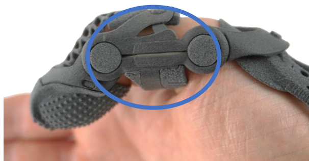
Figura 6: Mecanismo de desplazamiento del pulgar para el ajuste automático de la longitud durante el movimiento
