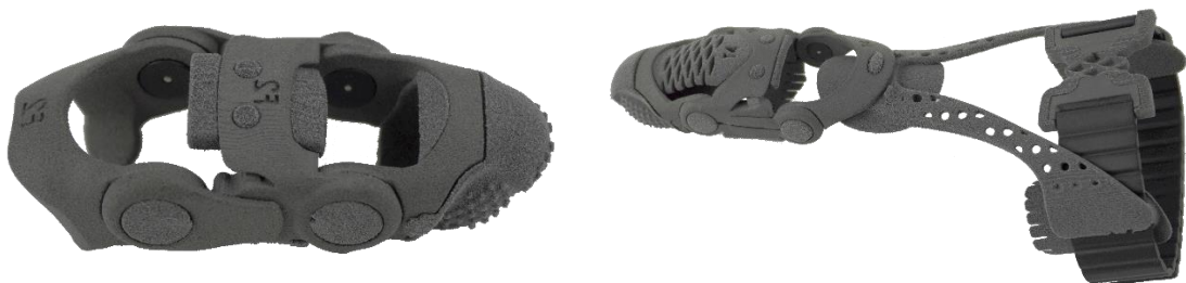
Abbildung 2. Die beiden Versionen des ARTUS Finger-Exoskeletts. Links: die ARTUS-Version für die Finger. Rechts: Die ARTUS-Version für den Daumen.
