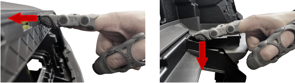
Figura 2: Dirección de empuje 1 (izquierda) Fuerza admisible hasta 5 kg / 50 N Dirección de empuje 2 (derecha) Fuerza admisible hasta 2 kg / 20 N
