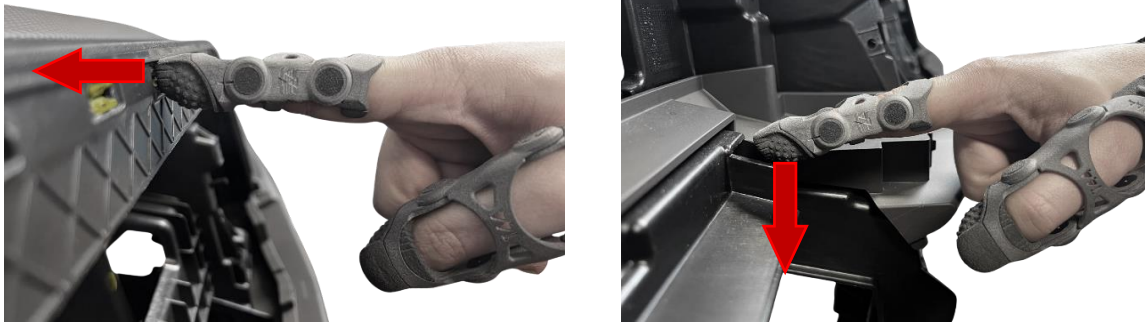
Abbildung 2. Druckrichtung 1 (links) Zulässige Kraft bis zu 5 kg / 50 N Druckrichtung 2 (rechts) Zulässige Kraft bis zu 2 kg / 20 N
